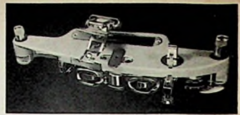
Kopfträger des Magnetophons M 5
